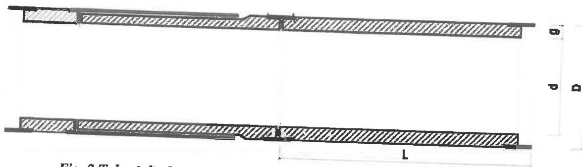
Fig. 2 Tuburi din beton armat pentru subtraversări montate prin împingere
