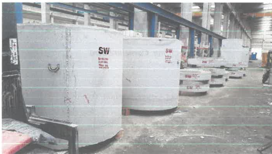
Foto: Camine de canaizare cu diametrul mai mare de 1250 mm (codificare prin vopsire)
